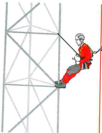
L'ouvrier en hauteur est maintenu par une longe ; il doit utiliser un système d'arrêt des chutes ; il est dans une situation cordiste.
