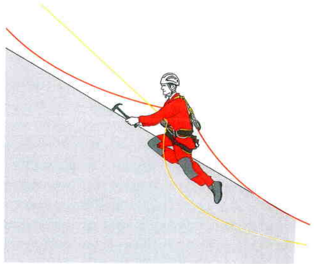
L'ouvrier en hauteur est maintenu par une corde; sans protection de bas de pente, il doit utiliser un système d'arrêt des chutes; il est dans une situation cordiste.
